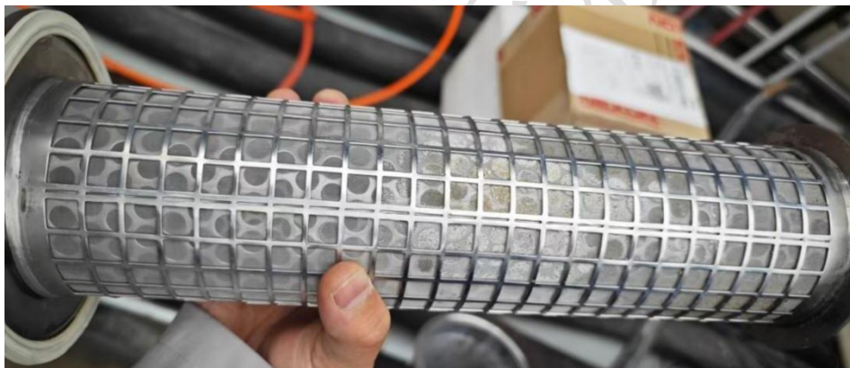
图 10-2 管道过滤器拆除示意图
