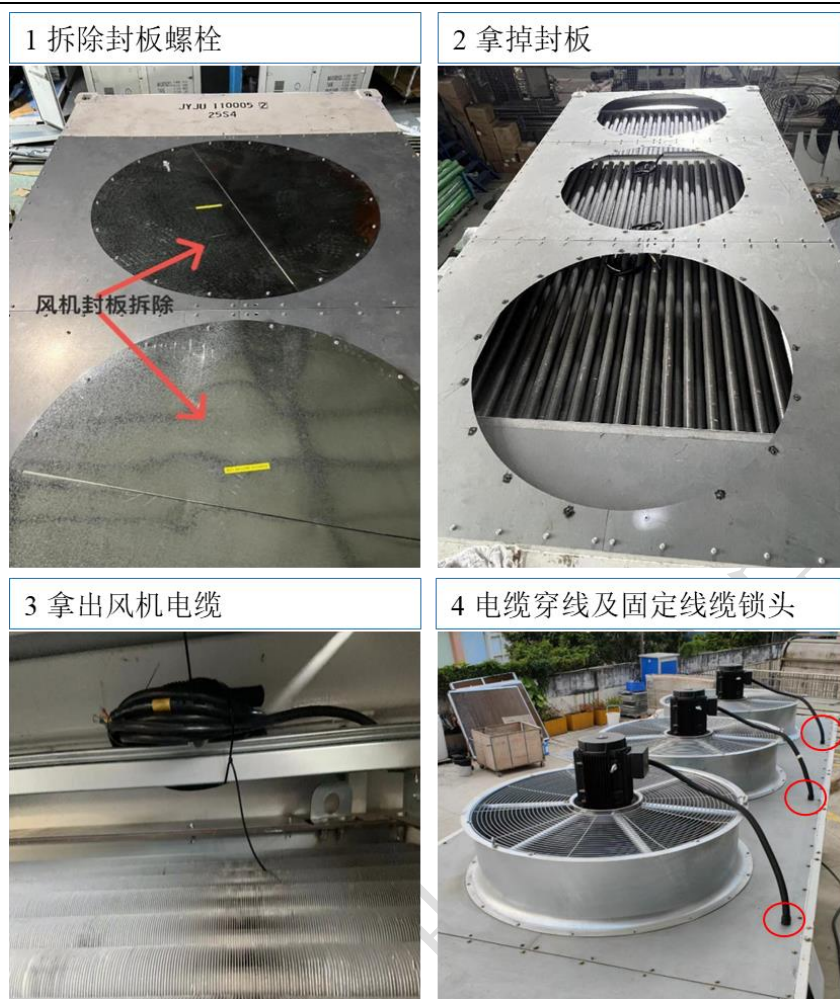
图 7-5 风机封板拆除示意图
