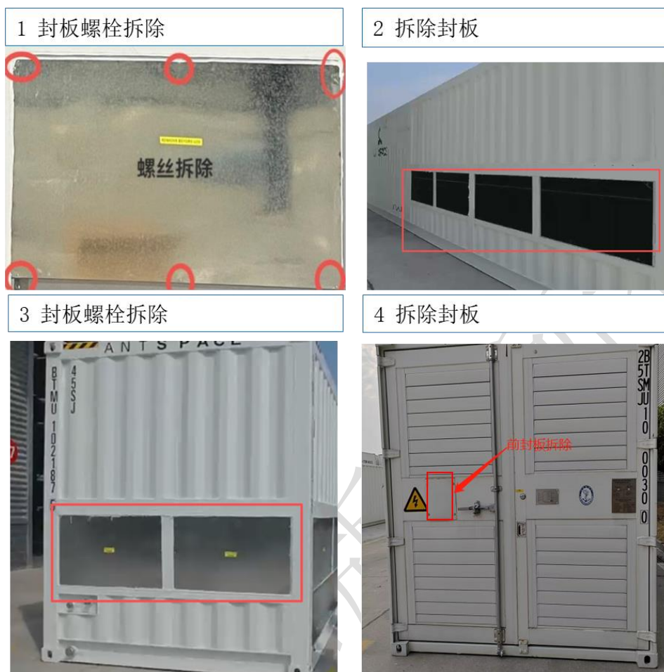
图 7-4 侧封板拆除示意图
